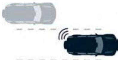
**Blind Spot Assist** - Può prevenire le collisioni. Se Defender rileva la presenza di un altro veicolo nel punto cieco quando si inizia a cambiare corsia, al volante viene applicata automaticamente una forza di rotazione che corregge la sterzata.
