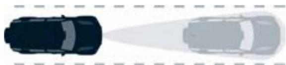
**Controllo adattivo della velocità di crociera** - Mantiene automaticamente l'auto a distanza di sicurezza da quella che la precede in caso di rallentamento o frenata di quest'ultima, sia quando si viaggia a velocità sostenuta, sia quando si rimane imbottigliati nel traffico. Se il veicolo che è davanti si ferma, la tua auto rallenterà sino a fermarsi completamente.
