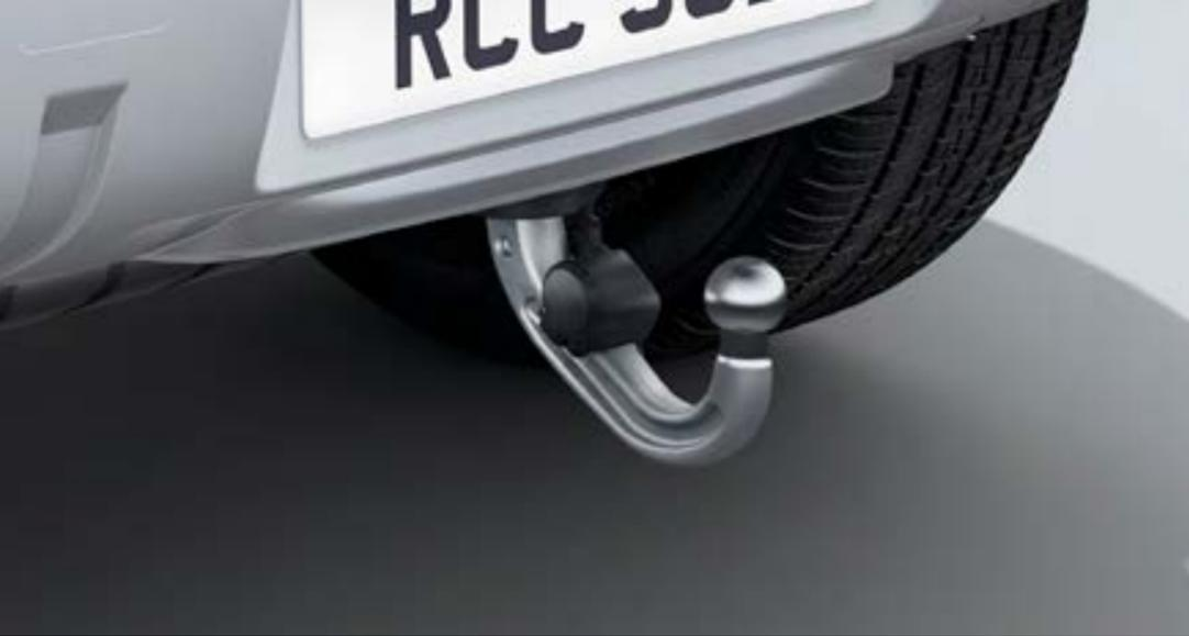
**Gancio di traino estraibile elettricamente** - Discretamente nascosto dietro il paraurti, offre un'estetica pulita. Progettato per l'estrazione e la scomparsa in 12 secondi, viene controllato mediante un interruttore ubicato nel vano di carico posteriore o mediante il sistema di infotainment nell'abitacolo.
