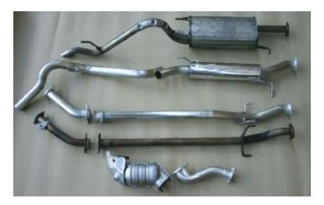
realizzate in presenza di gas neutro iniettato nei tubi stessi e mantenuto a bassa pressione per rimuovere presenze d'acqua. Dopo aver ripulito i tubi su una bobina a grana fine lo scarico è pronto per essere installato sul veicolo.
