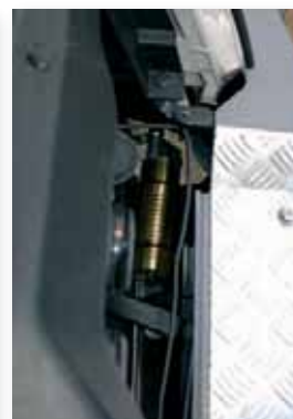
Sospensioni L'assetto è stato irrigidito e rialzato di 5 cm con molle da carico e ammortizzatori a gas Oram. I serbatoi degli ammortizzatori anteriori sono stati posti dietro il paraurti, quelli posteriori su apposite staffe fissate al telaio.
