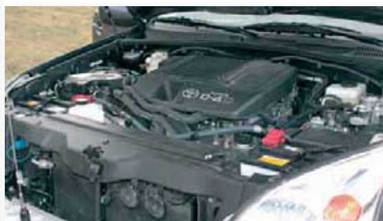
Motore Il 3.0 D-4D da 173 CV è rimasto di serie. Sono solo stati aggiunti un prefiltro/decantatore per il gasolio e un filtro gasolio originale maggiorato. Volendo, la Totani può installare una centralina aggiuntiva che porta la potenza a 200 CV.
