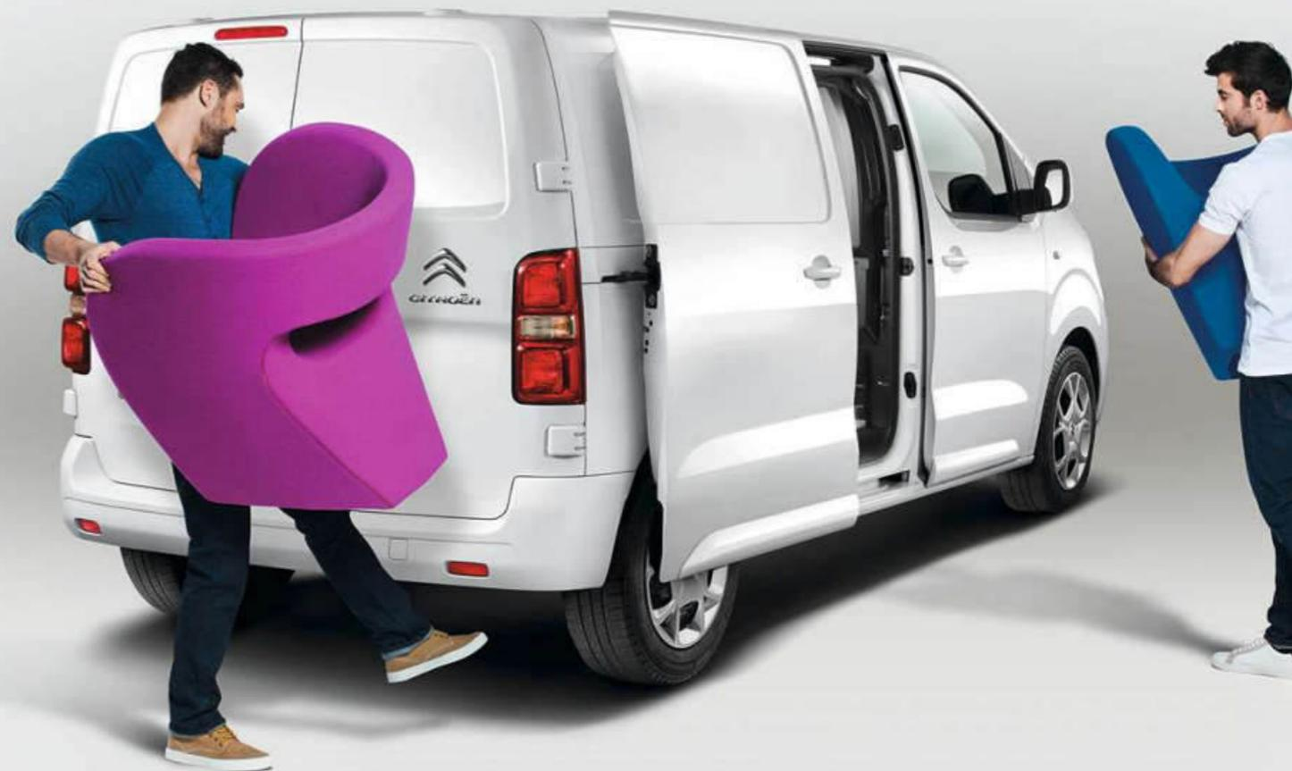
Come aprire e chiudere le porte laterali quando si hanno entrambe le mani occupate? Con la tecnologia «Hands-Free Sliding Side Doors\*» di Citroën Jumpy è sufficiente passare il piede nell'angolo sotto il paraurti posteriore per azionare l'apertura automatica delle porte. Non è più necessario utilizzare le maniglie o appoggiare il carico, spesso fragile. Con lo stesso gesto si possono anche richiudere le porte, bloccando così il veicolo. Pratico, ingegnoso e unico.
