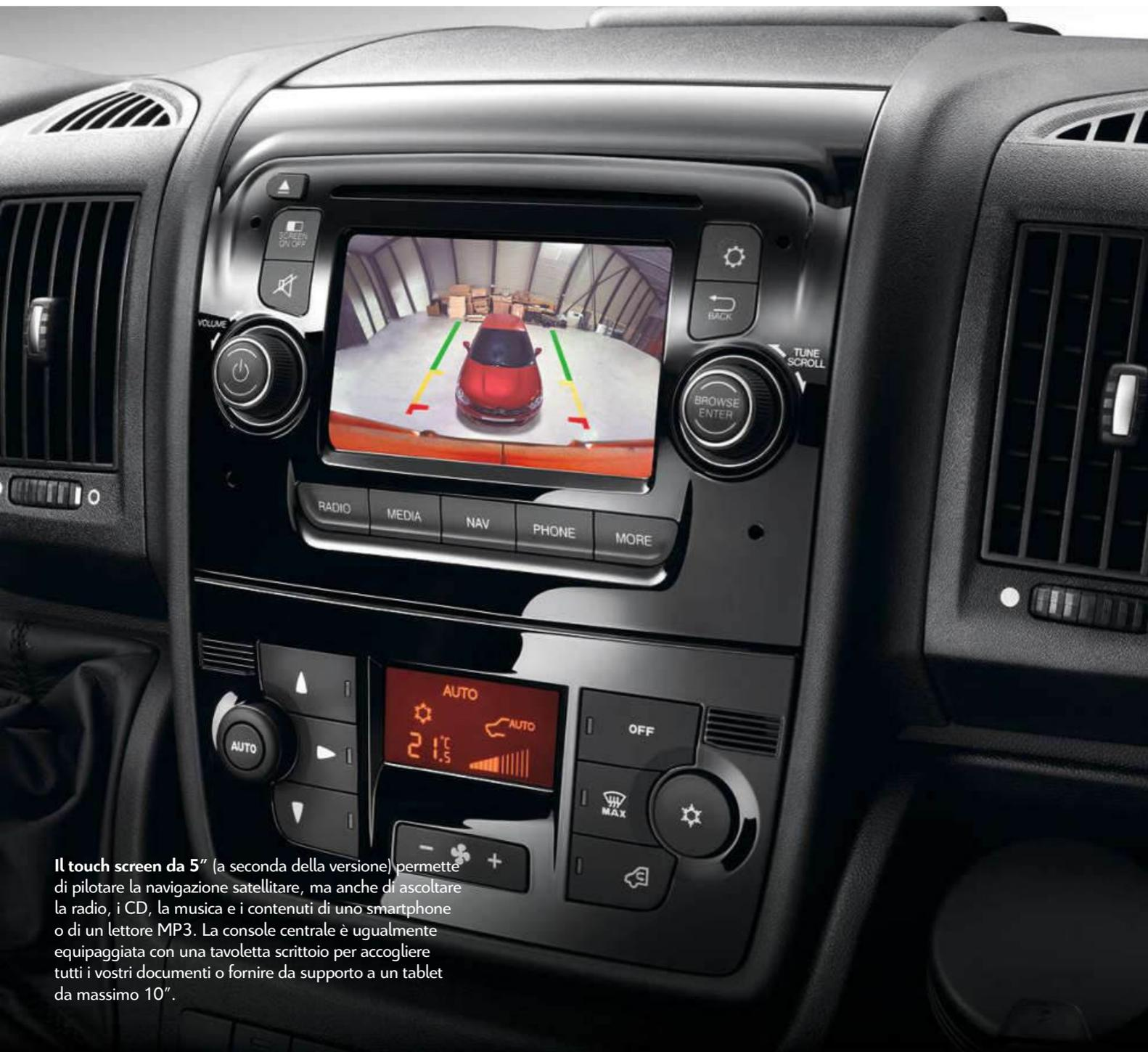
Il touch screen da 5" (a seconda della versione) permette di pilotare la navigazione satellitare, ma anche di ascoltare la radio, i CD, la musica e i contenuti di uno smartphone o di un lettore MP3. La console centrale è ugualmente equipaggiata con una tavoletta scrittoio per accogliere tutti i vostri documenti o fornire da supporto a un tablet da massimo 10".
