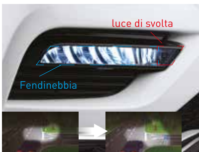
Gruppo ottico che integra luce di svolta e fendinebbia con tecnologia a LED
