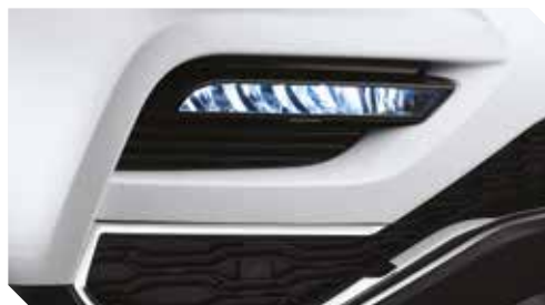
Luce di svolta a LED integrata nei fendinebbia
