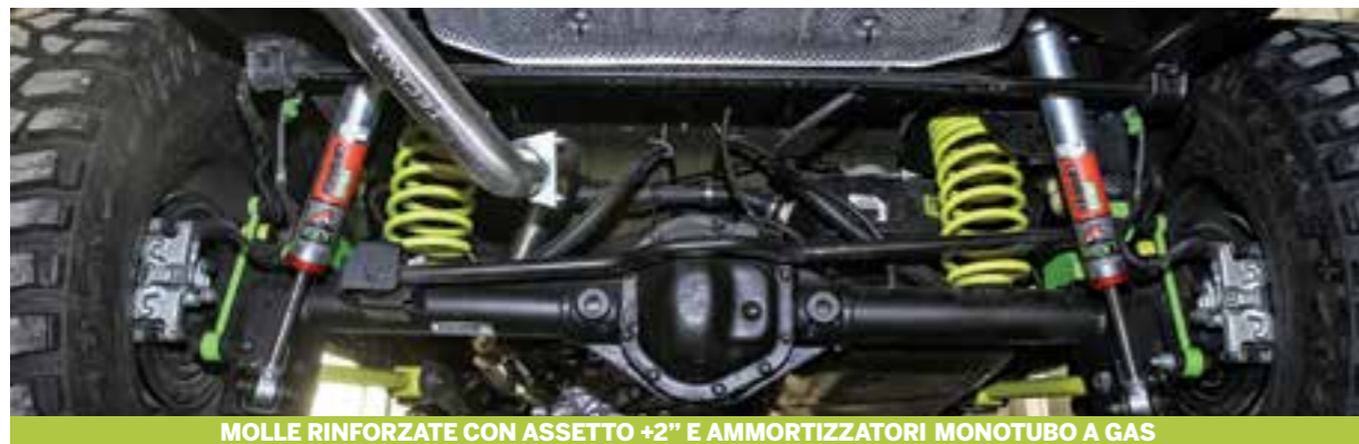
MOLLE RINFORZATE CON ASSETTO +2" E AMMORTIZZATORI MONOTUBO A GAS
