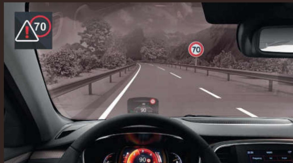
**Riconoscimento della segnaletica stradale con allerta superamento limite.** Il sistema adatta la tua guida in base ai dati della segnaletica stradale rilevati dalla fotocamera, mantenendo il limite sempre visibile sull'Head-up display.
