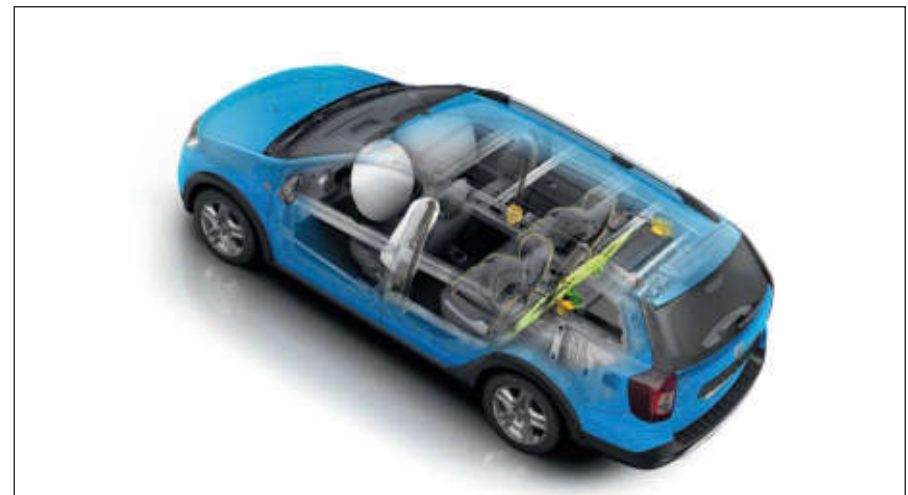
Protezione: carrozzeria con struttura rinforzata, airbag frontali e laterali anteriori, sistema di fissaggio ISOFIX sui sedili laterali posteriori.
