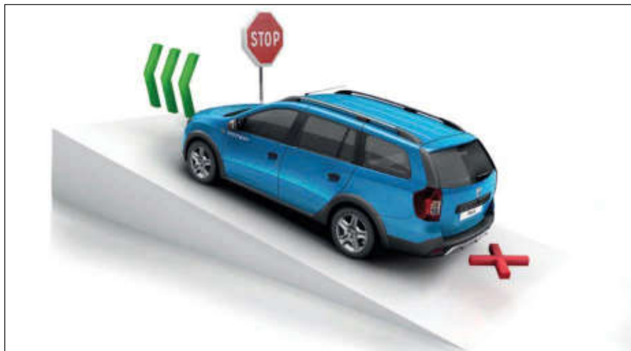
Assistenza alla partenza in salita: In caso di partenza in salita, il sistema mantiene automaticamente la corretta pressione sul freno per 2 secondi per lasciare al conducente il tempo di impostare la manovra.
