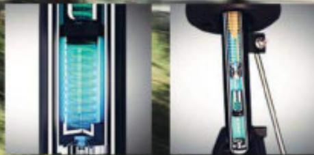
*Sulle compressioni e le estensioni più importanti molla e ammortizzatore lavorano insieme agli smorzatori idraulici di compressione e estensione rallentando i movimenti in modo progressivo ed evitando bruschi arresti di fine corsa, eliminando così il fenomeno del «rebound».*
